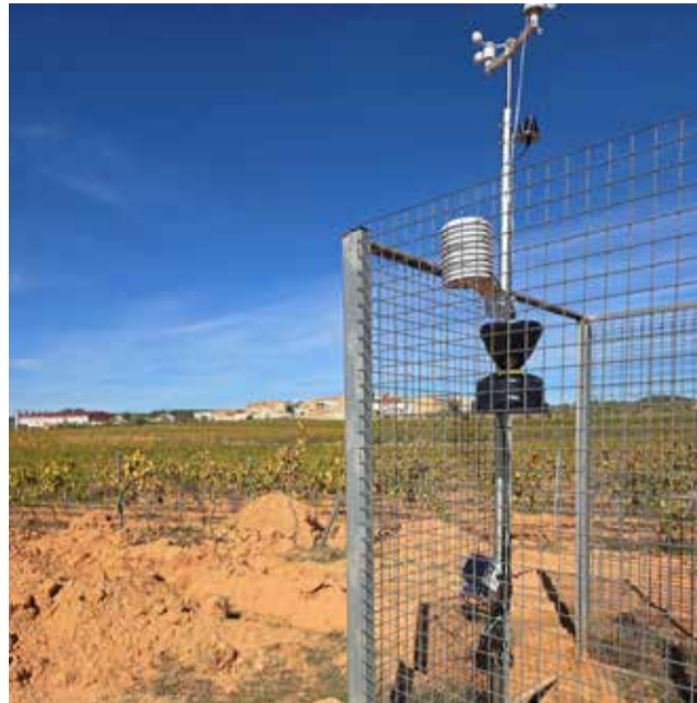
Estación meteorológica, lisímetro y contador digital instalados en el acuífero Requena-Utiel. / EPDA
